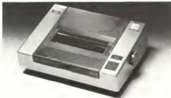
**Radio Shack Line printer mod. VII.** Nella vasta gamma di stampanti Radio Shack disponibili in Giappone troviamo anche una costruttrice Seiksha, già nota in Italia, con possibilità di indirizzare anche parti singole, costa solo 79.000 yen. Ma più interessante ci sembra il modello visibile nella foto: ben più costoso, ma dotato di elementi di scrittura con penna a sfera e capacità grafiche, tanto da essere denominato Printer Plotter 350.000 yen.
